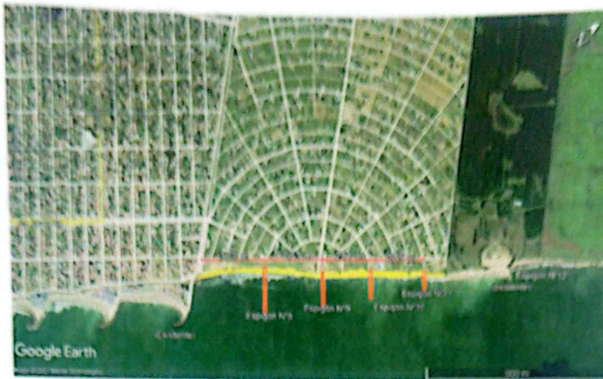
Figura 6: Sistema de Espigones de transición y Relleno Artificial de Arena. Elaboración DEA-DPH
